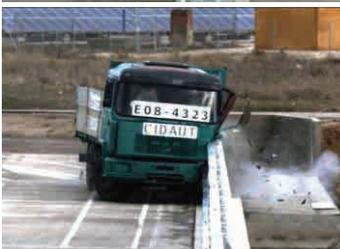
**Essai:** TB61 (camion de 16.000 Kg. a 80 Km/h y 20°)
